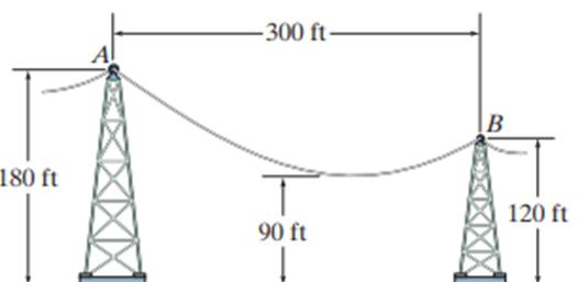
$$h_A := 180 \text{ ft} \quad h_B := 120 \text{ ft} \quad h_O := 90 \text{ ft} \quad d := 300 \text{ ft}$$
